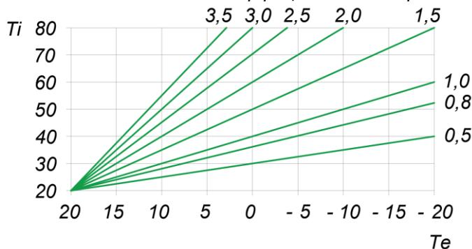
Значения температурных криевых для  $T_{Room} = 20^{\circ}\text{C}$
